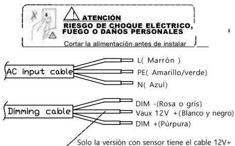
⚠ Las conexiones de los cables deben estar protegidas correctamente
