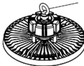
La argolla puede ser sustituida por un gancho de sujeción.
