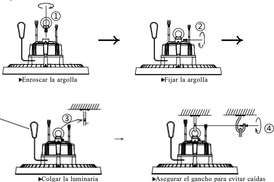
Si la campana tiene cable de seguridad, se puede usar durante el montaje
