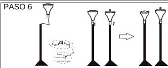
Cableado e instalación Instale la luminaria en el poste como se muestra en la figura, y conecte el cableado siguiendo el esquema. Fije la luminaria con el tornillo ALLEN M8\*35mm suministrado.
