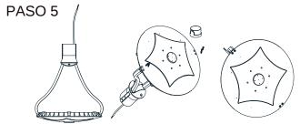
Ajuste y fije los brazos a la luminaria. Instale ambos brazos de soporte en la luminaria y fíjelos con los tornillos M6\*20mm suministrados.
