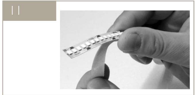
Corte la tira a la longitud deseada y haga los empalmes necesarios, luego destape la cinta adhesiva de la parte posterior.
