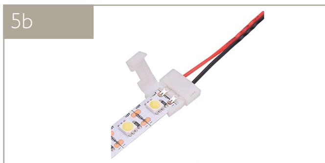
Identifique el cable rojo (+) y el cable negro (-) del conector. Alinee las conexiones (+) y (-) de la tira LED según corresponda y, a continuación, introdúzcala suavemente en el conector. Asegúrese de que los contactos de ambas partes queden conectados.
