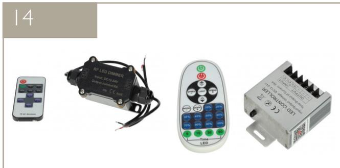
En caso de querer usar un controlador, elija el modelo que más se ajuste a sus necesidades. Verifique siempre que el controlador y la tira son compatibles. **Si no necesita controlador, conecte la tira directamente al transformador.**
