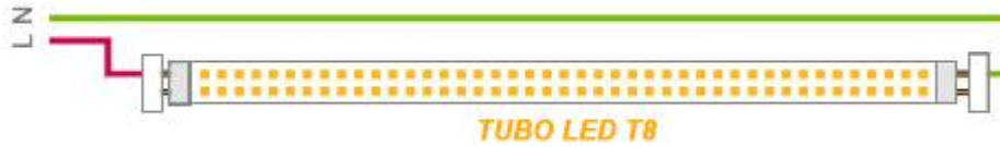
Imagen 7: Esquema para tubo LED de conexión por dos extremos
