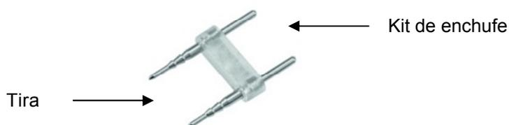
5. La tira es a prueba de salpicaduras (IP 65), lo que lo hace adecuada para aplicaciones en exteriores. No obstante, hay que aislar los empalmes, el kit de enchufe y la tapa final con cola o tubo termorretráctil para asegurar la estanqueidad.
