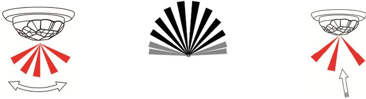
Detección óptima (paso perpendicular)
